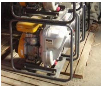
可搬式排水ポンプ
