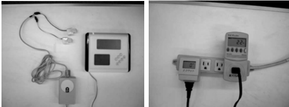
左：電力消費量や電気代がリアルタイムでわかる「省エネナビ」 右：コンセントで消費電力がわかるエコワット・ワットチェッカー
