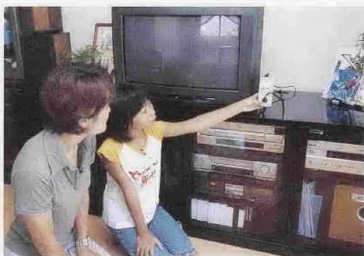
簡易電力計を使って、テレビの待機時消費電力を調べています。
