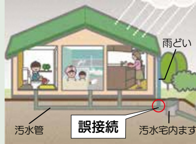
分流式の地域において、敷地内の雨水を集める管が、誤って汚水管につながっていること
