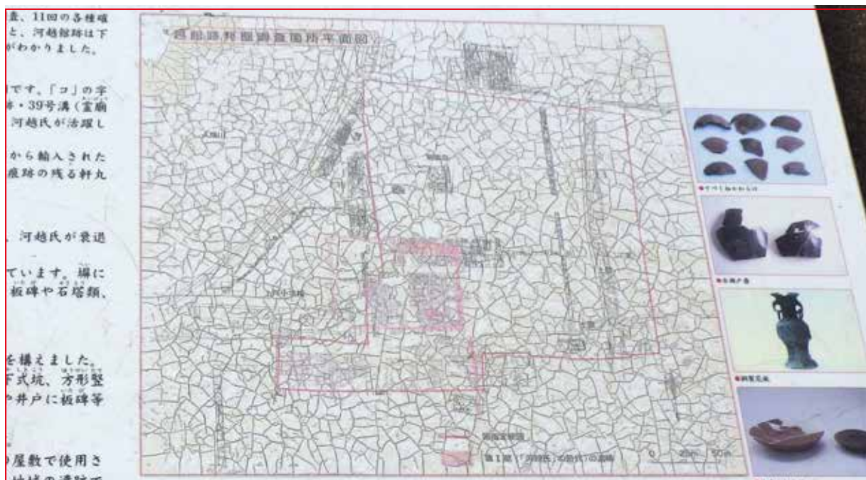
修正フィルムがひび割れた解説サイン（下段写真は上段写真内赤枠部分の拡大）
