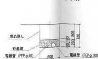
電線管断面図 S=1/100
