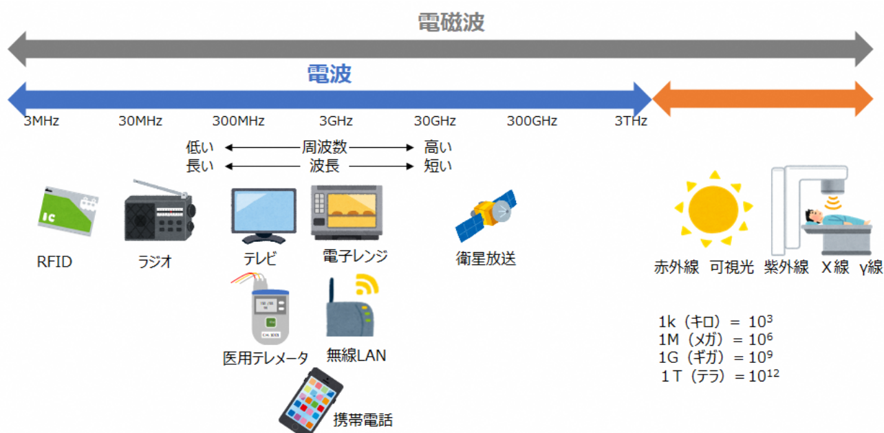
参-図1 電波と電磁波
