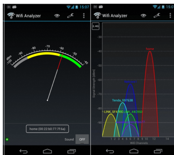
図 35 スマートフォンのアプリケーションでの無線 LAN 電波の状況表示例
