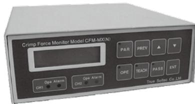
自動車の「神経回路」であるワイヤーハーネスを瞬時に検査する装置。製造しながら不良品を検出できるため、作業員の負担が軽減される
