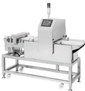
微小な金属異物を検出できる特殊磁気センサーを搭載。食品の検査などに威力を発揮
