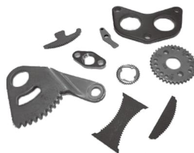
従来の汎用プレス加工では不可能とされた厚板(6mm以上)加工やシェービング加工、カーボンの打ち抜き加工を実現。安価かつ大量生産を可能とした
