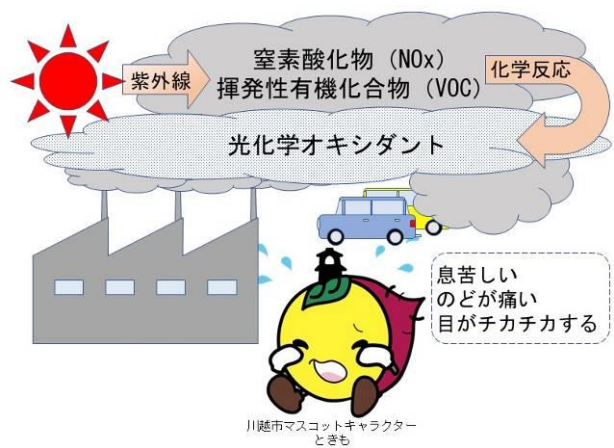
図5-2-4 光化学スモッグ発生のしくみ
