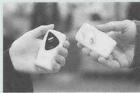
左側が職員用。右側が来庁者用。来庁者用の機器が振動して、呼び出しの合図を送ります。
