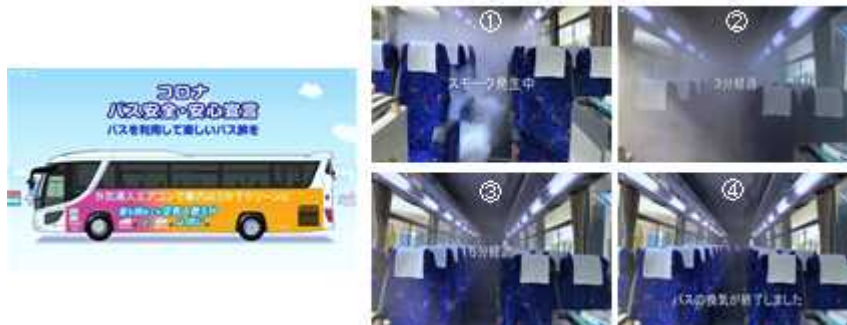
車内換気テストの例(貸切バス)
